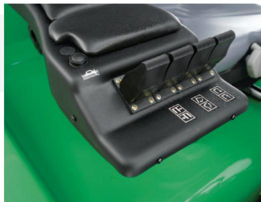
L' accodoir ergonomique avec Mini-Joystick ou mini leviers (Fingertips) optionnels avec commande électro-proportionnelle, permettent l'optimisation des fonctions de manutention de la charge.
