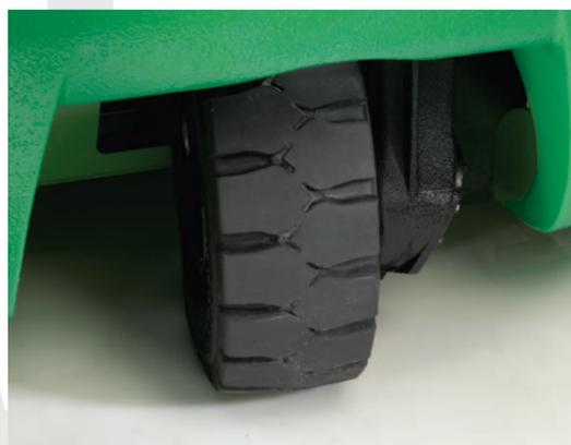
La possibilité de tourner de 180° la roue centrale arrière et les dimensions réduites de l'appareil optimisent la manœuvrabilité, même dans les espaces restreints ou dans des largeurs d'allée réduites.
