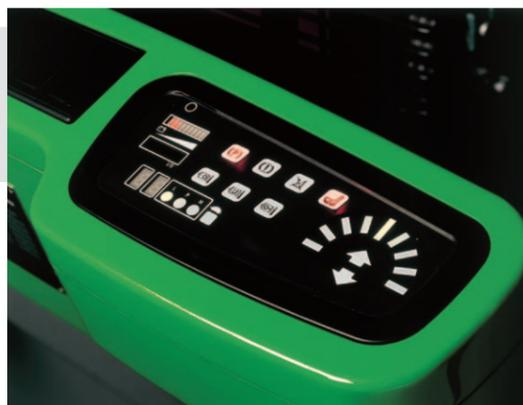
Le tableau de bord, style automobile, possède les voyants des principales fonctions ainsi qu'un écran pour l'identification rapide des codes défaut. De plus, nous avons un indicateur de position des roues arrières.
