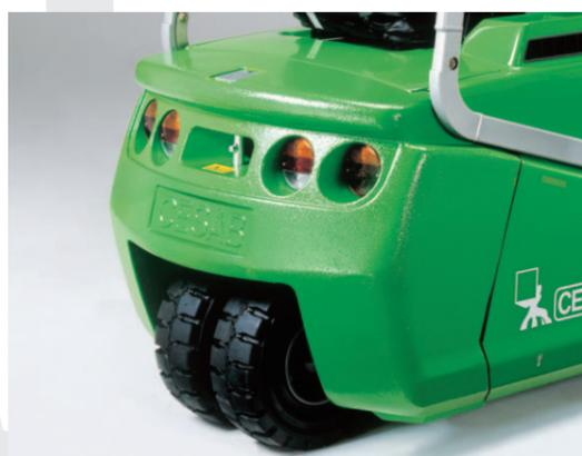
Avec son centre de gravité bas, la conception à trois roues d'une extrême stabilité utilise deux AC moteurs indépendants puissants montés dans les roues avant, de manière à former un différentiel électronique qui permet de travailler dans les espaces les plus étroits.
