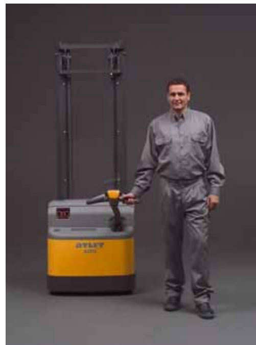
Le positionnement du timon permet au cariste de marcher à côté du chariot.
