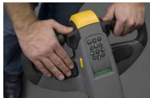
Toutes les commandes sont aisément accessibles sur le timon ergonomique.
