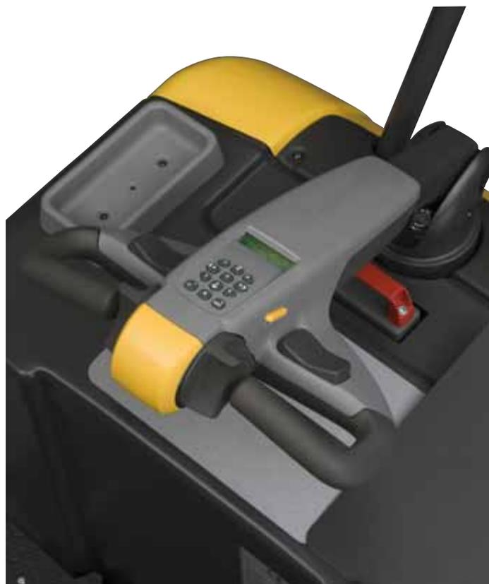
Le timon ergonomique Atlet est de série sur tous les modèles. La nouvelle commande Ergo steering est proposée en option.
