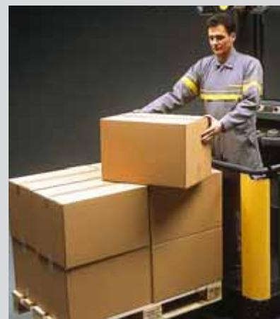
L'Ergolift® d'Atlet est le levage des fourches indépendant pour la préparation de commandes sur palette. Toujours à la bonne hauteur pour poser les marchandises. Le système de fourches est très peu encombrant et ne gêne pas la préparation. Capacité de charge pour tous les modèles : 1000 kg.
