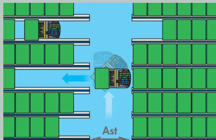
La largeur d'allée (Ast) peut être ramenée à 2265 mm. Pour la circulation des chariots sur deux voies et la manutention des palettes sur la longueur, la largeur effective de l'allée est d'environ 3000 mm.
