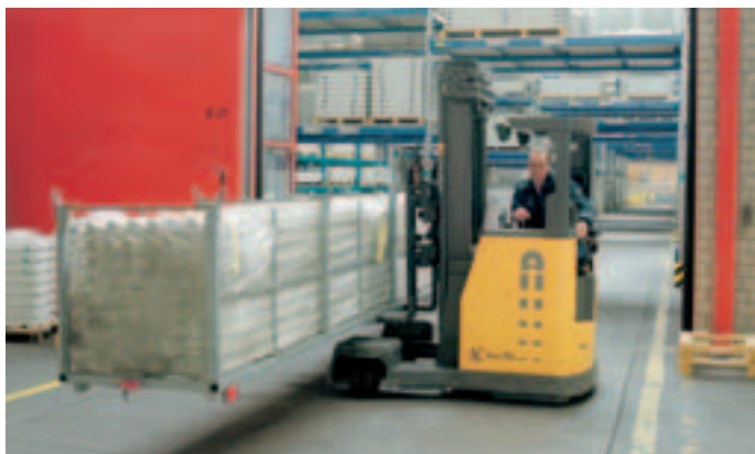
Le mât grande visibilité procure une bonne visibilité pour la manutention et le transport.
