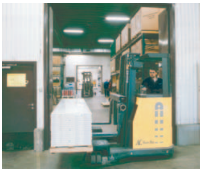
Les portes étroites sont le problème majeur avec les charges longues. Le déplacement latéral est la seule solution.
