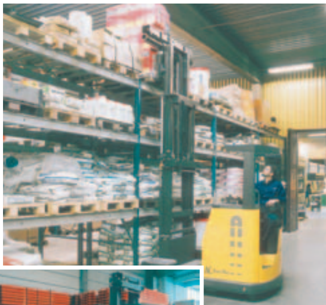
Manutention flexible dans les cantilevers pour la manutention des charges à des niveaux supérieurs, le cariste s'appuie sur le dossier et le siège s'incline de 15 degrés.
