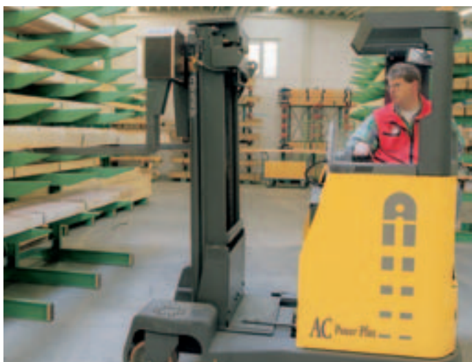
Le mât grande visibilité procure une bonne visibilité pour la manutention et le transport.
