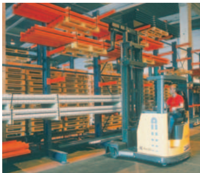
Manutention flexible dans les cantilevers pour la manutention des charges à des niveaux supérieurs, le cariste s'appuie sur le dossier et le siège s'incline de 15 degrés.
