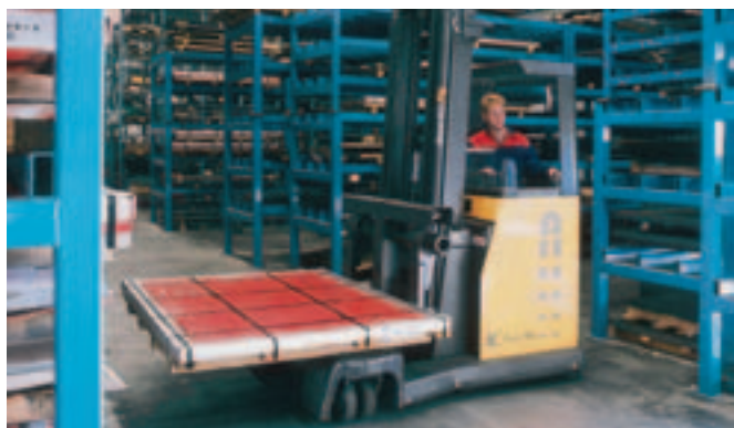
La trajectoire est précise et régulière lors des déplacements latéraux. Facteurs très importants pour la rapidité et la sécurité.
